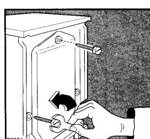
Удалите три пластмассовых винта и заткните пустые отверстия тремя пластмассовыми заглушками, находящимися на задней стороне машины.
