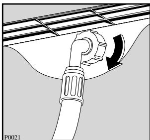
**OBS!** Även om du inte behöver vrida slängen skall du alltid kontrollera att muttern är åtdragen.
