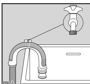
**Lattiakaivoon:** Yhdistä tyhjennysletku seinään kiinnitettynä putkeen. Putken yläpää ei missään tapauksessa saa olla matalammalla kuin 60 cm eikä korkeammalla kuin 80. cm. Katso kuva.
