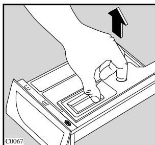
Стиральный порошок скапливается и в углублении дозатора. Для чистки углубления можно использовать старую зубную щетку.
