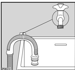
**Anslutning till golvbrunn:** Fäst ett rör på väggen, 60-80 cm från golvet och anslut avloppsslängen till röret. Avloppsslängens ändstycke skall vara ventilerat, d.v.s. rörets invändiga diameter skall vara min. 40 mm. Se till att slängen sitter fast och inte kan lossna.
