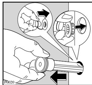
**OBS!** Spara transportsäkringarna om maskinen vid någon senare tidpunkt skall transporteras igen.
