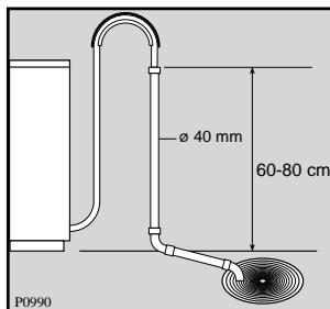
**Anslutning till vattenlås:** Då avloppsslängen ansluts till ett vattenlås under en tvätt- eller diskho, måste du kapa pipen på vattenlåset för att få största möjliga öppning så att maskinen kan tömmas ordentligt.
