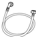
Шланг подачи воды
