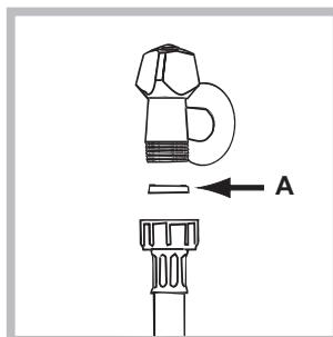
1. Вставьте прокладку A в конец водопроводного шланга и привинтите его к водопроводному крану холодной воды с резьбовым отверстием 3/4 дюйма (см. схему). Перед подсоединением откройте водопроводный кран до тех пор, пока из него не потечет чистая вода.
