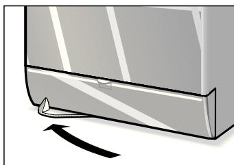
Поверните рычаг внизу с передней стороны машины справа налево. В результате этого она окажется стоящей на роликах.
