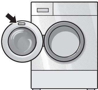
Эти данные Вы найдете в фирменной табличке, расположенной изнутри на раме дверцы загрузочного люка и, взятые в жирную рамку, на обратной стороне машины.
