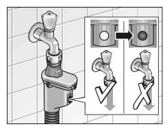
Шланг «Aqua-Secure» служит для предотвращения возможности затопления в результате негерметичности шланга. В случае нарушения герметичности шланга на дисплее появляется красная отметка, и перекрывается подача воды.
