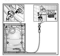
После присоединения шланга откройте водопроводный кран и проверьте место соединения на герметичность. Следите за давлением воды в водопроводной сети.
