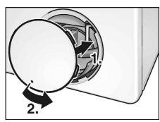
Установите на место откидную крышку цоколя машины и закройте ее. Во избежание того, чтобы при первой стирке неиспользованное моющее средство сразу не попало в канализацию:
