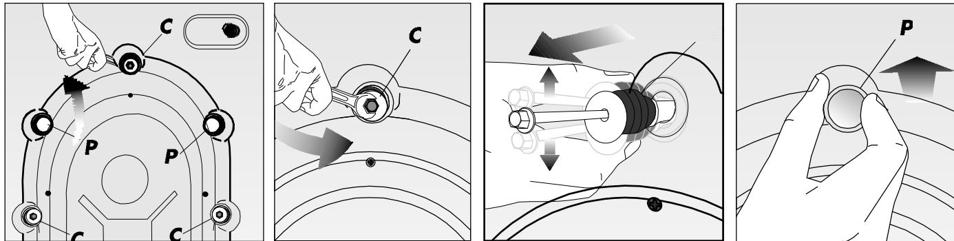
Болты, на головках которых имеется обозначение «С» выворачивать против часовой стрелки до тех пор пока они без труда могут быть извлечены.
