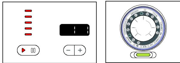
При завершении программы стирки горят индикаторные лампочки всех выполненных этапов и на дисплее отображается общее время выполнения программы. Это значит, что машина готова к следующей стирке. Для того, чтобы выключить машину, нажмите кнопку "Включить/Выключить" (On/Off).
