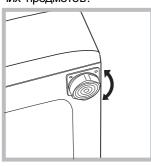
2. После установки машины на место отрегулируйте ее устойчивое положение путем вращения передних ножек (см. рис.). Для этого сначала ослабьте контргайку, после завершения регулировки контргайку затяните.
