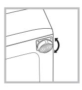
2. Se il pavimento non fosse perfettamente orizzontale, compensare le irregolarità svitando o avvitando i piedini anteriori (vedi figura); l'angolo di inclinazione, misurato sul piano di lavoro, non deve superare i 2°.
